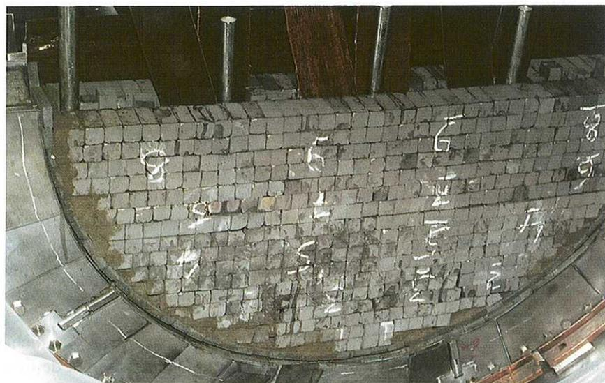
Figura 5. Sección de la cámara experimental Rasplav mostrando la carga inicial de corium.
