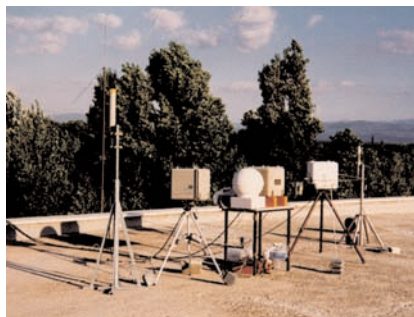
► Figura 2. Medidas de radiación gamma ambiental realizadas con distintos equipos.
