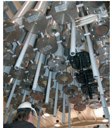
► Figura 5. Maqueta de entrenamiento para actuaciones de soldadura y trabajos diversos, ubicada en la central nuclear de Cofrentes.
