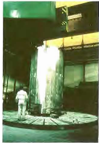
Figura 3. Contenedor Ensa-DPT para almacenamiento de combustible gastado.
