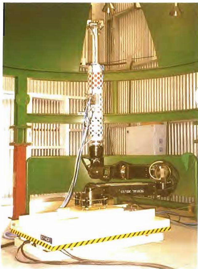
► Figuras 2 y 3. A la izquierda, inspección de penetraciones de tapas de vasijas PWR-Potava. Arriba, módulos de inspección Sicom.
