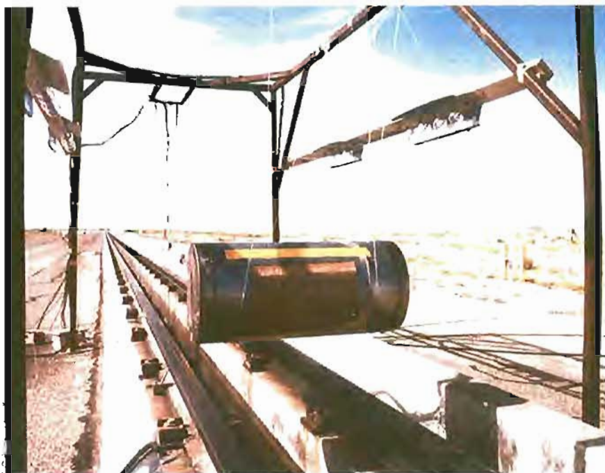
► Figura 3. Ensayo de impacto a alta velocidad sobre un bulto a escala para transporte por vía aérea.
