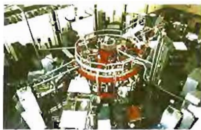
► Figura 8. Aspecto del TJ-II rodeado de sistemas de diagnóstico. Sobresalen las torres del sistema Thomson Scattering (derecha) y HIBP (izquierda). Laboratorio Nacional de Fusión, Ciemat.
