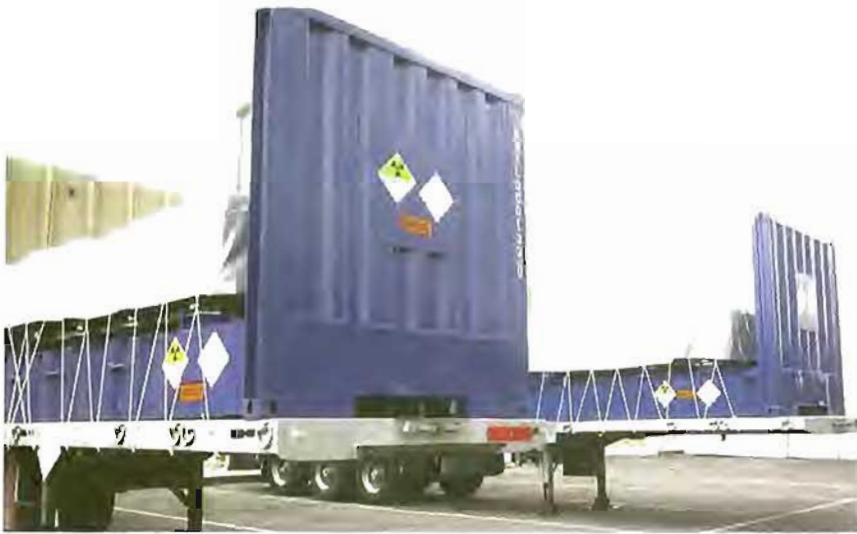
► Figura 1. Transporte de bultos de material fisionable.
