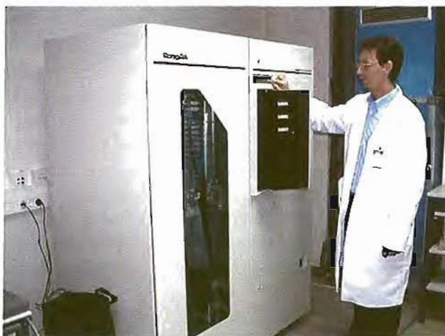
► Figura 10. Imagen de un sistema de archivo a largo plazo de un sistema PACS.
