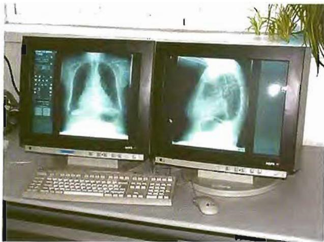
Figura 6. Imagen de una estación de visualización para diagnóstico clínico de un PACS.
