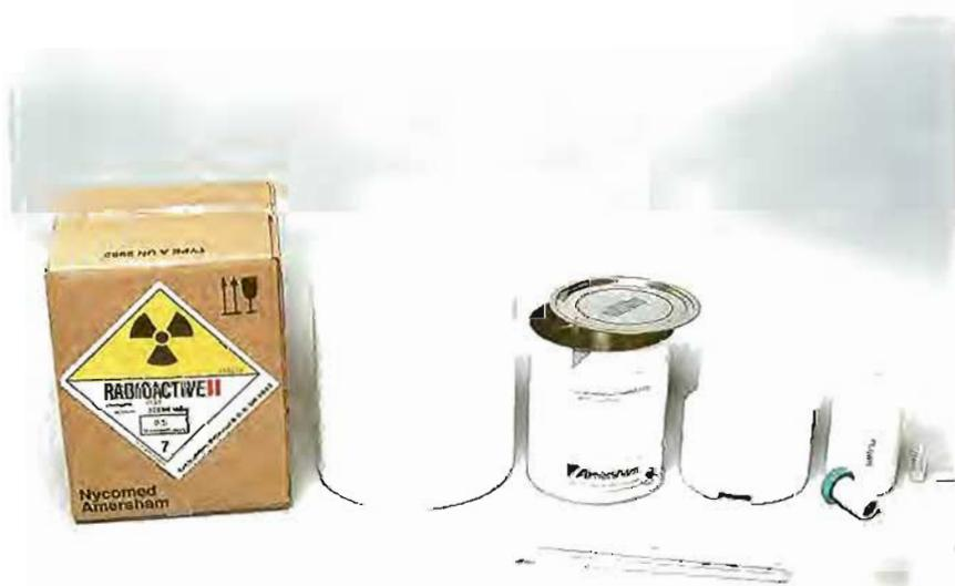
Figura 4. Imagen de los distintos componentes de un bulto tipo A con vial de fuente no encapsulada.
