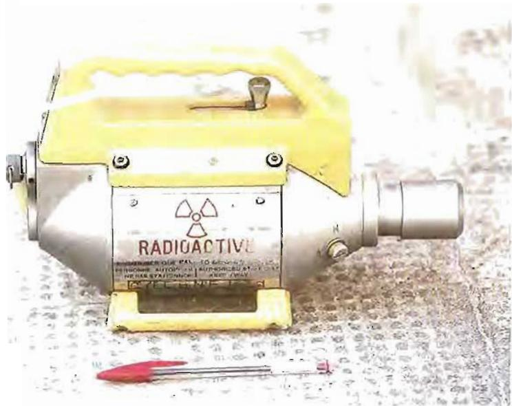
Figura 1. Equipo de gammagrafía industrial.
