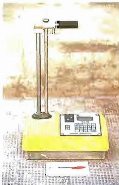
● Figura 3. Medidor de humedad y densidad de suelos.
