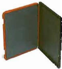
► Figura 2. Imagen de un chasis y una placa de fósforo fotoestimulable.
