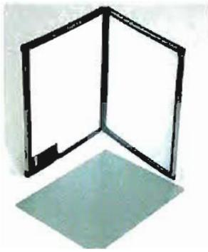
► Figura 1. Chasis convencional con sus cartulinas y la película radiográfica.
