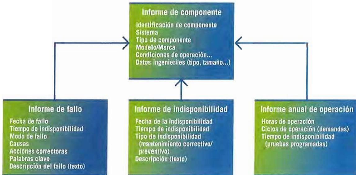
Figura 3. Estructura del Banco de Datos de Componentes (BDC).
