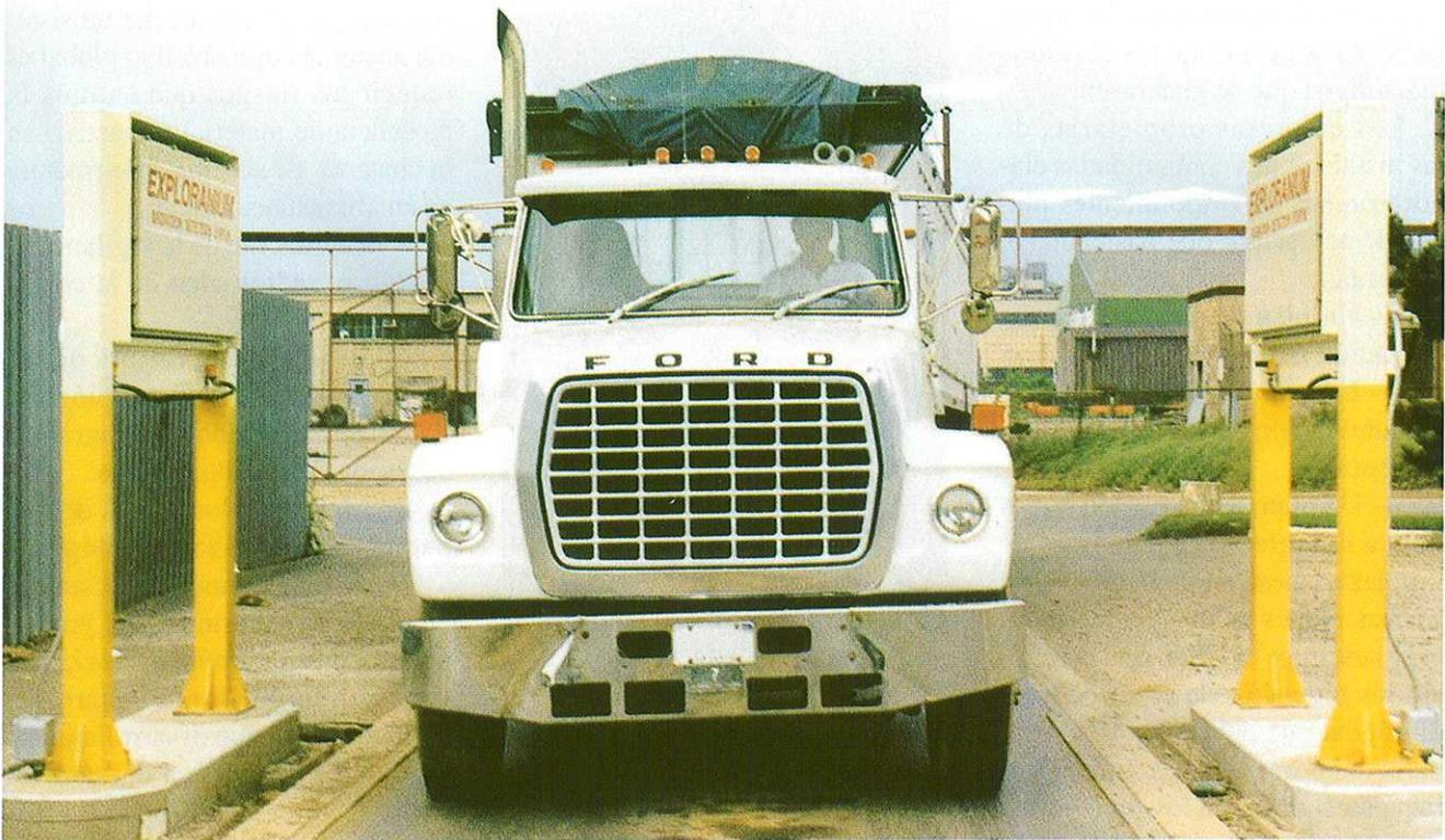
► **Figura 1.** Detector de pórtico para la inspección radiológica automática de camiones.
