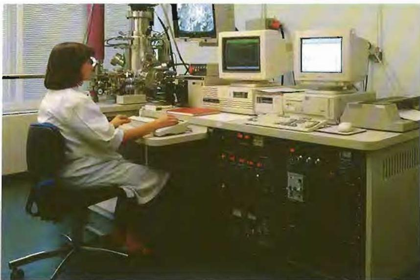
► Figura 2. Sistema Auger de análisis de superficie del Ciemat.
