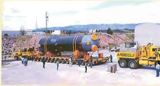
Transporte y cambio de generadores de vapor en Ascó II.
