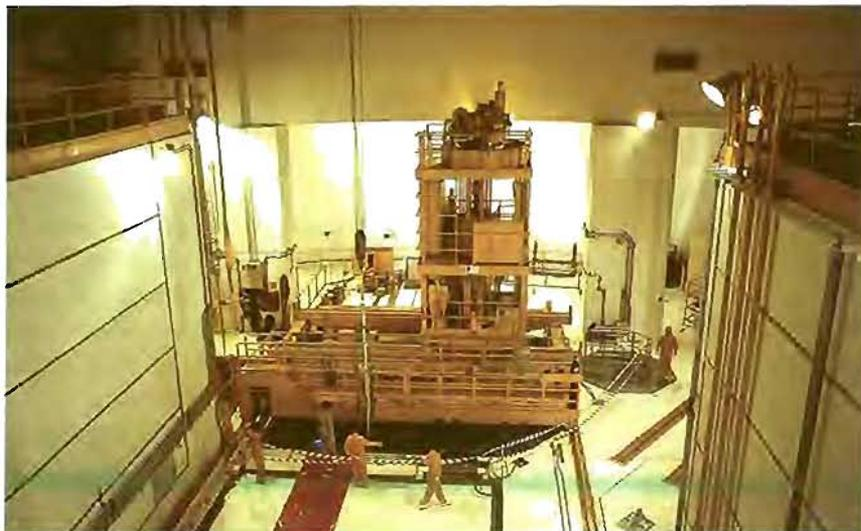
Figura 3. Proceso de carga en la central nuclear de Cofrentes.
