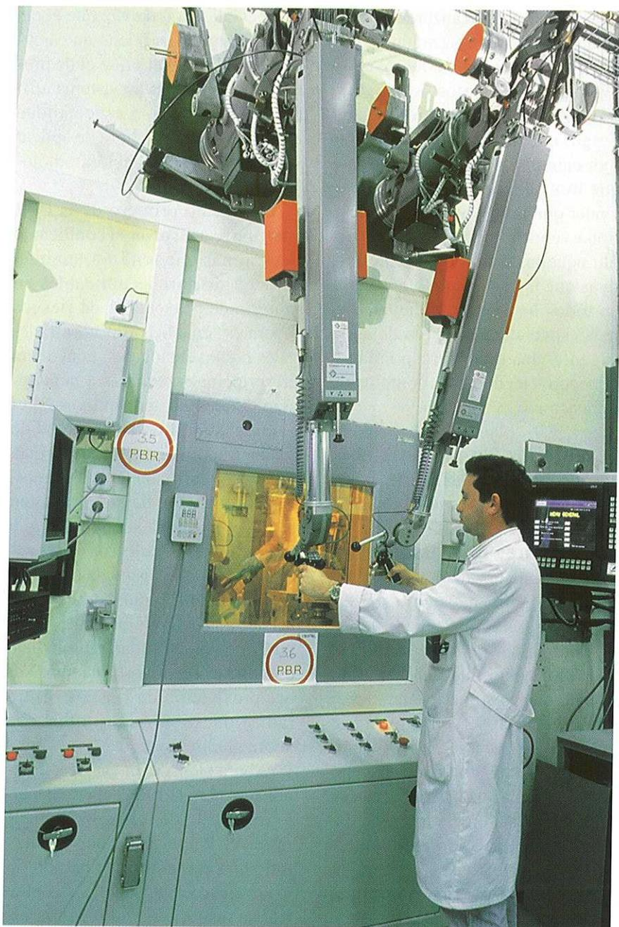
► **Figura 1.** Proceso de caracterización de un residuo radiactivo.
