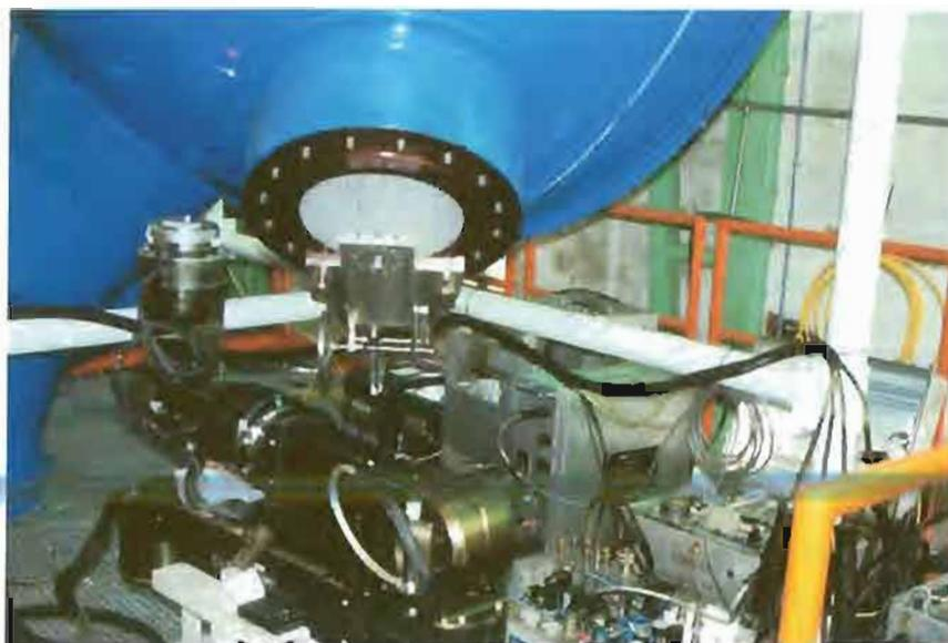
► Figura 7. Proyecto de aplicaciones automáticas al mantenimiento nuclear. Inspección de la caja de aguas de un generador de vapor.
