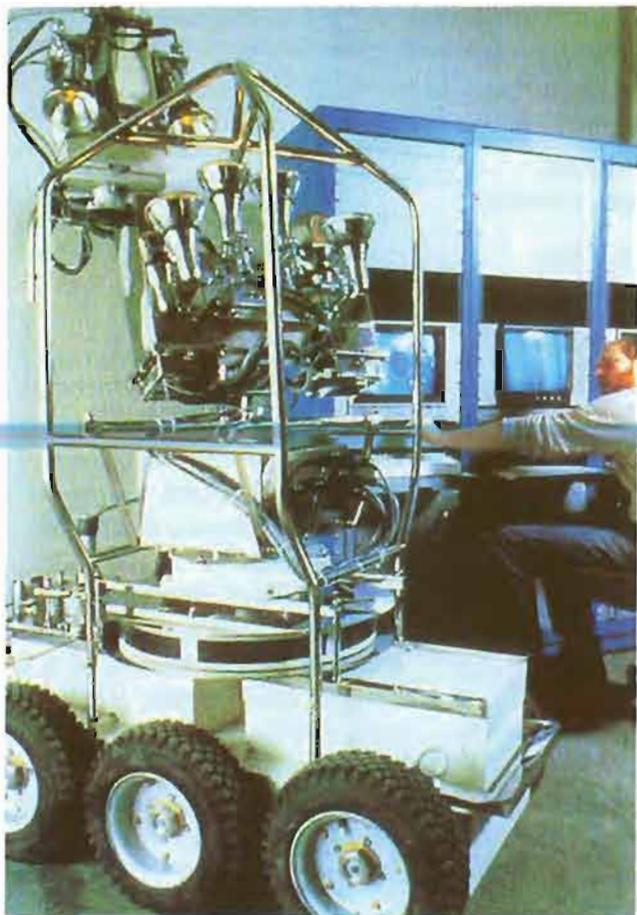
► Figura 1. Rover I, vehículo de inspección remota utilizado en la siniestrada central nuclear de TMI-II.
