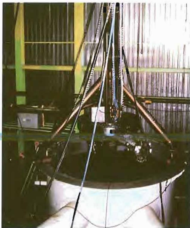
► Figura 4. Equipo de inspección por ultrasonidos del interior de las vasijas de reactores de agua ligera. Este equipo de Tecnatom, S. A. ha sido utilizado con profusión en España.
