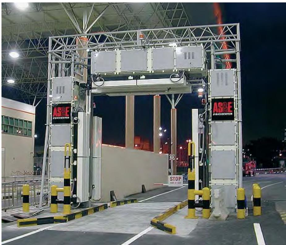
Los sistemas de inspección por rayos denominados *fast scanning* permiten el escaneado de la carga con el vehículo en movimiento. Estos equipos disponen de sistemas de seguridad redundantes para evitar el escaneado de la cabina.
