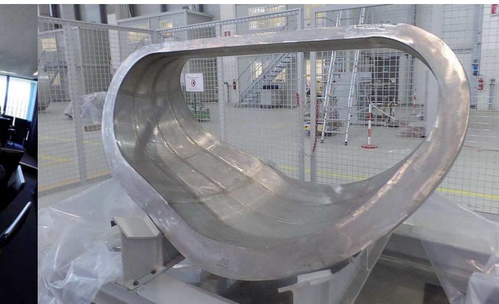
Sección de la cámara de un tokamak, reactor de fusión por confinamiento magnético.
