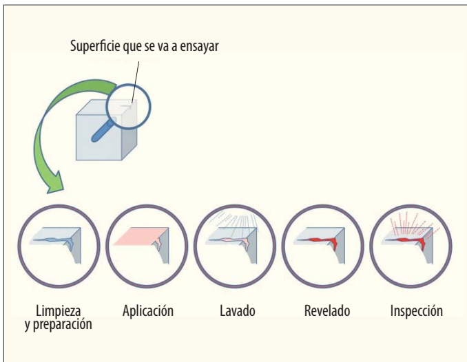
Figura 1. Proceso de líquidos penetrantes.
