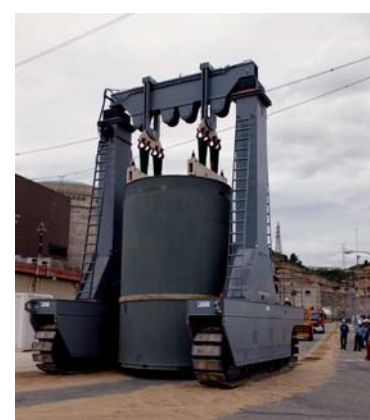
Figura 6. Componentes del sistema con cápsula multipropósito. Vistas de los ATI de José Cabrera en la parte superior y de Ascó en la parte inferior y del traslado del módulo cargado a esta última instalación.
