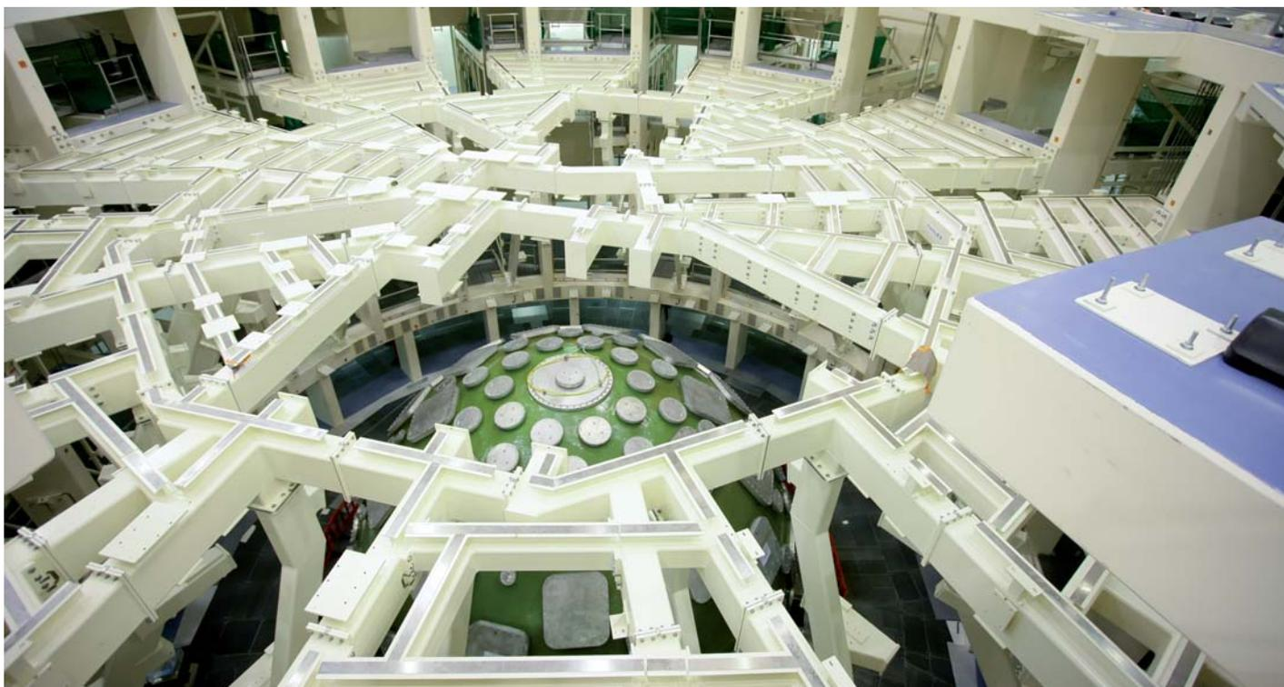
Aspecto exterior de la cámara de ignición de la instalación francesa Laser MegaJoule.
