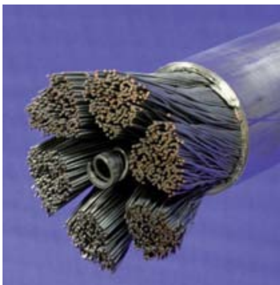
Detalle de los cables superconductores que envuelven el anillo toroidal. El tubo central alberga el helio líquido que enfría los cables.
