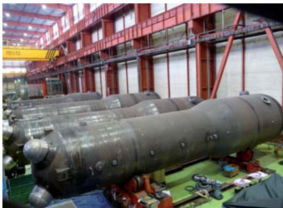
Generadores de vapor en las instalaciones de ENSA.
