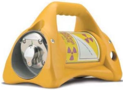
Figura 5. Equipo de gammagrafía industrial.
