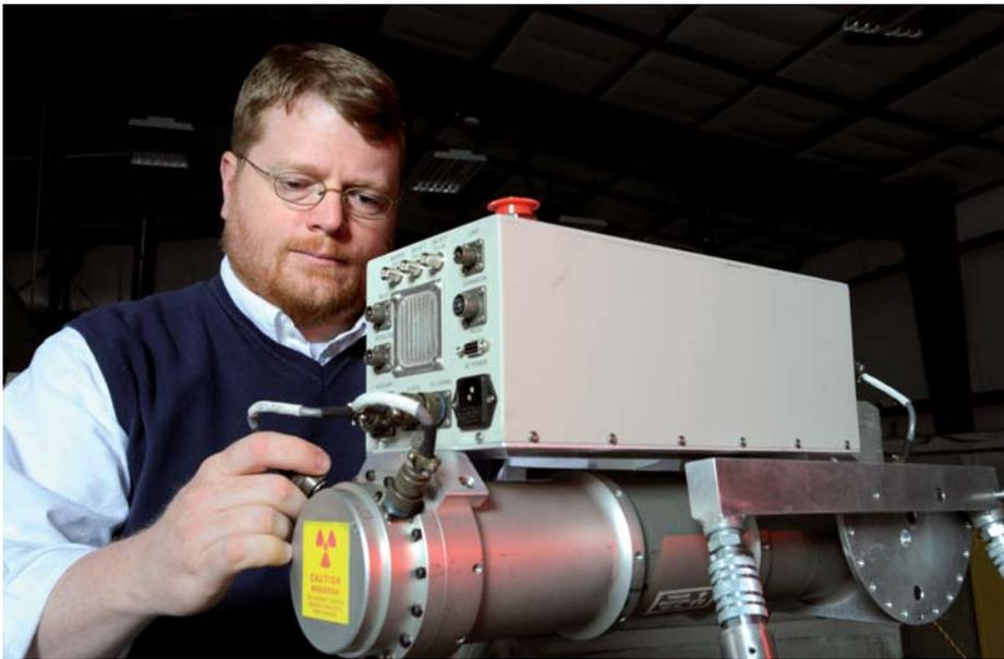
Generador electrónico de neutrones utilizado en laboratorio.
