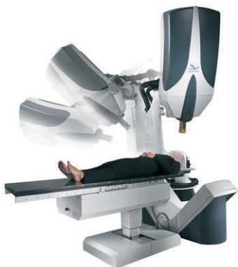
Los últimos avances en el campo de la radioterapia guiada por la imagen vienen de la mano de aparatos robóticos como el *CyberKnife*, que utiliza un brazo robótico y un microacelerador que sigue los movimientos del paciente para posicionar el haz de radiación sobre el tumor. Se utiliza principalmente en tumores de pequeño tamaño. Gracias a la flexibilidad del brazo robótico, el sistema es capaz de llegar a lugares del cuerpo que son inaccesibles para otros sistemas de radiocirugía.
