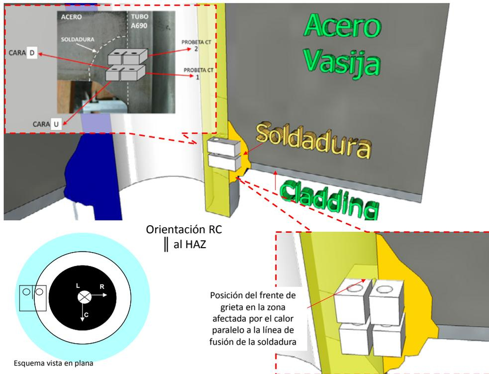
Figura 7. Esquema de la posición de las probetas respecto a la soldadura. Esta disposición se referirá más adelante en la exposición de resultados, detalle de la orientación RC paralela al HAZ.
